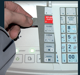
Wymienna wkładka klawiatury w modelu kasy z klawiaturą membranową
