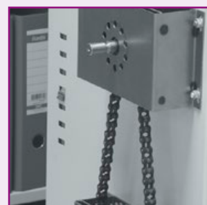
Solidny mechanizm korbowy – duże przełożenie, łatwość przesuwu.
