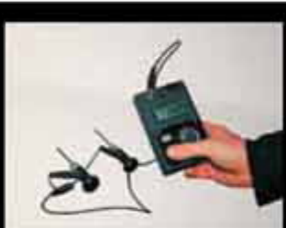
elektryczny pomiar oporności
