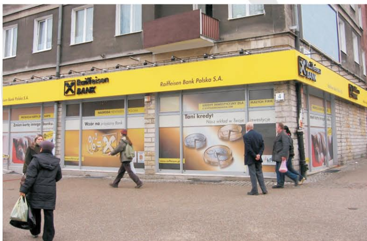
Oznakowanie zewnętrzne banku - otok winylowy z literami brytowymi ze styroduru. Logo zewnętrznie podświetlone halogenami na wysięgnikach.
