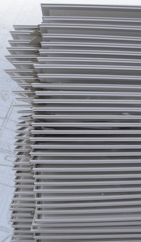
Korpus kasetonu świetlnego z napinanym licem winylowym.
