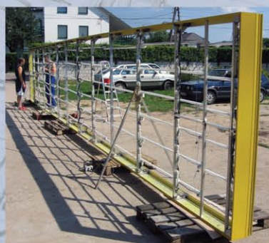
Korpus kasetonu świetlnego z napinanym licem winylowym.
