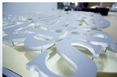
Litery przestrzenne na dystansach wycięte ploterem frezującym.
