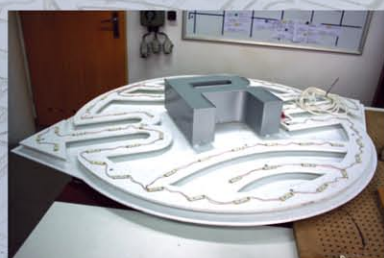
Montaż liter brylowych podświetlanych diodami (LED).
