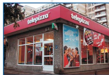
Otok winylowy narożny, logotyp wykonany jako litery brytowe ze styroduru; podświetlenie zewnętrzne - halogeny na wysięgnikach.
