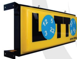
Kaseton dwustronny, korpus kasetonu walcowany, lico tłoczone, nadruk metodą sitodruku, wokół korpusu ozdobna drewniana rama.
