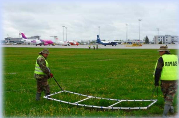
Prace saperskie na terenach portów lotniczych przy użyciu dużego wykrywacza ramowego oraz magnetometru różnicowego dla głębszego sprawdzenia terenu
