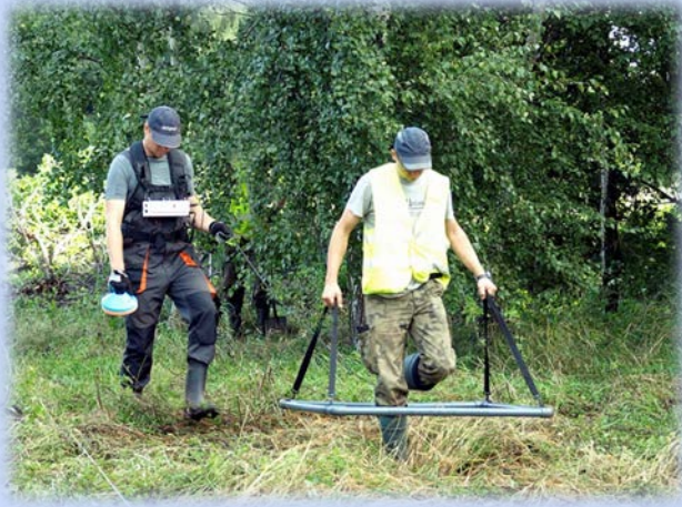
Prace saperskie na polach przy użyciu małego wykrywacza ramowego
