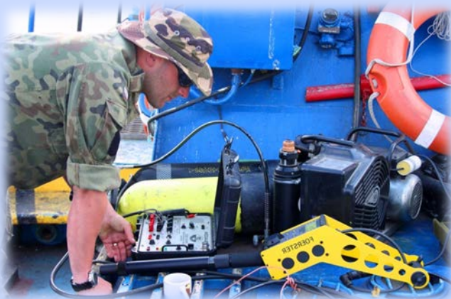
Poszukiwanie i namierzanie przedmiotów metalowych, w tym wybuchowych za pomocą magnetometrów różnicowych z sondami podwodnymi
