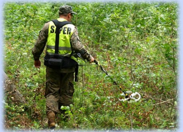
Prace saperskie w lasach przy użyciu jednocewkowego wykrywacza metali
