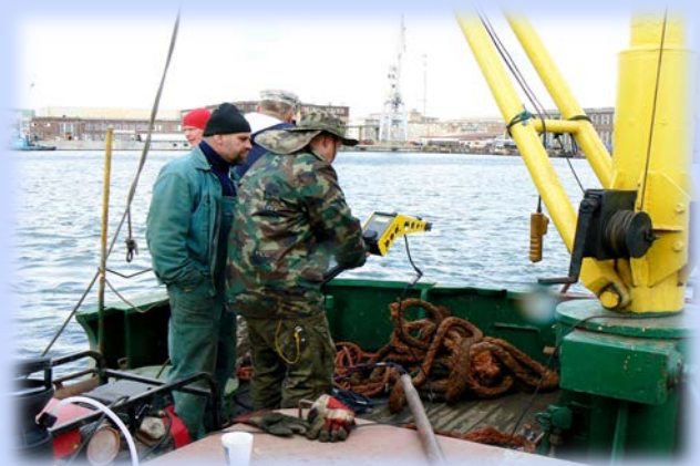
Poszukiwanie i namierzanie przedmiotów metalowych, w tym wybuchowych za pomocą magnetometrów różnicowych z sondami podwodnymi
