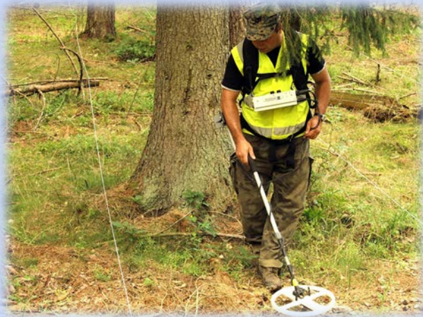
Prace saperskie w lasach przy użyciu jednocewkowego wykrywacza metali
