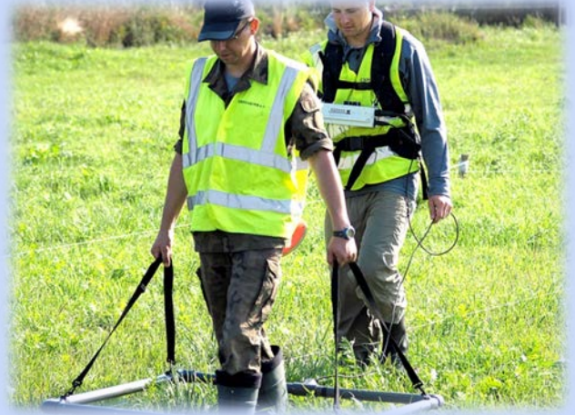
Prace saperskie na polach przy użyciu małego wykrywacza ramowego
