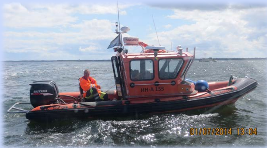
Jednostka do ustawiania oznakowań w miejscach zlokalizowania przedmiotów metalowych/wybuchowych
