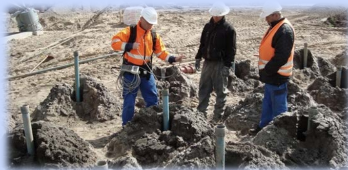
Badania magnetometryczne na obecność niewybuchów w miejscach wierzeń badawczych (geologicznych)
