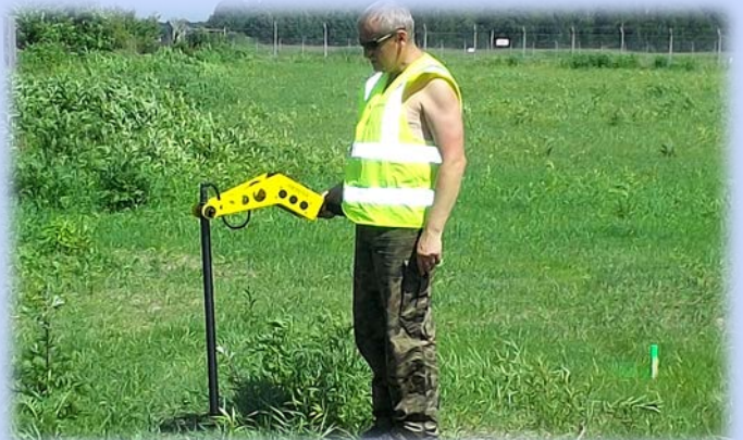
Prace saperskie na terenach portów lotniczych przy użyciu dużego wykrywacza ramowego oraz magnetometru różnicowego dla głębszego sprawdzenia terenu
