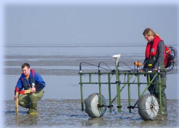
Zestawy magnetometrów z systemami DGPS i rejestratorami danych do ich późniejszej obróbki
