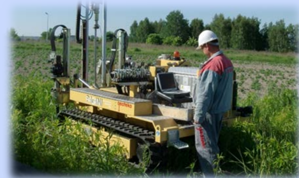
Badania magnetometryczne na obecność niewybuchów w miejscach wierzeń badawczych (geologicznych)
