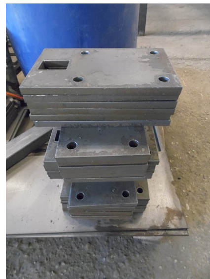
-marki montażowe pod profil
