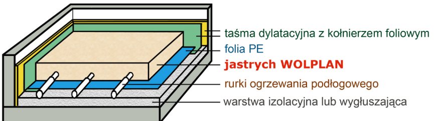
Jastrych ogrzewany ciepłą wodą
