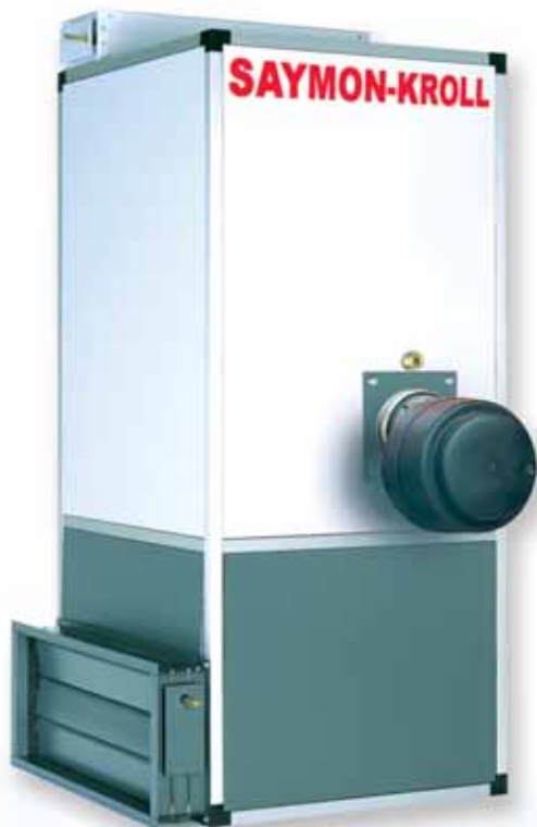
Piec nadmuchowy – urządzenie wentylacyjno-grzewcze Saymon-Kroll typu S, wersja AquaAir. Urządzenie zapewnia wentylację i ogrzewanie ciepłym powietrzem w układzie bezpośrednim lub kanałowym oraz ciepłą wodę do instalacji centralnego ogrzewania i podgrzewania wody użytkowej
