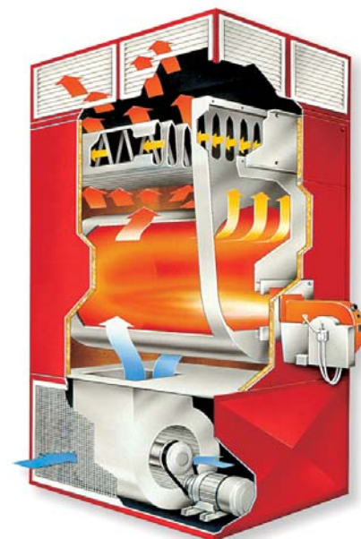
Rys. 2. Przepływ powietrza w kotle nadmuchowym Saymon-Kroll
