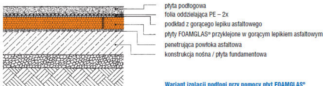
Wariant izolacji podłogi przy pomocy płyt FOAMGLAS®
