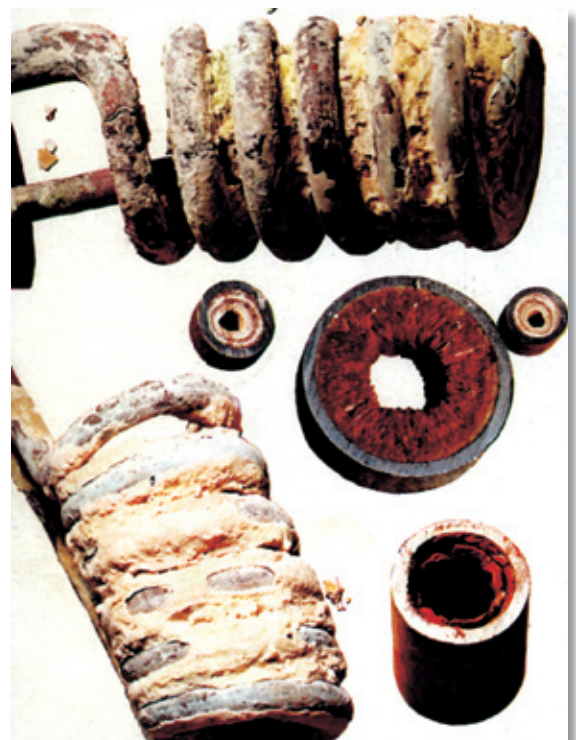
Obecne w wodzie sole wapnia i magnezu są przyczyną powstawania kamienia kotłowego
