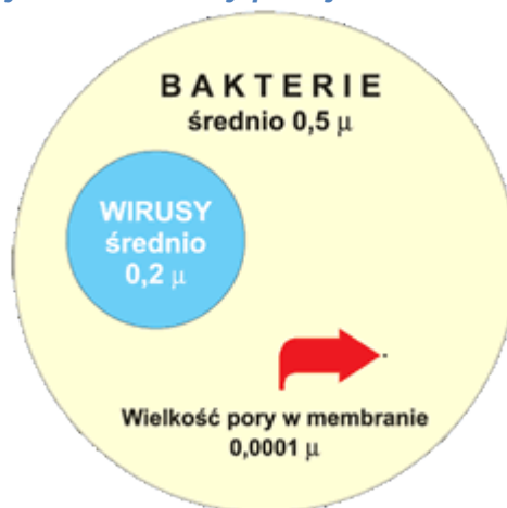
Rys. Pory membran osmotycznych stosowanych do oczyszczania wody pitnej są kilka tysięcy razy mniejsze od bakterii.
