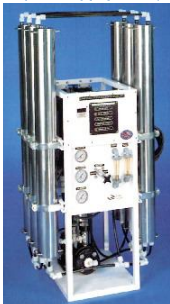
Rys. Osmotyczny agregat półprzemysłowy. Wydajność - 5 m 3 /godz.
