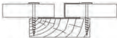
Połączenie na dwuteownik
