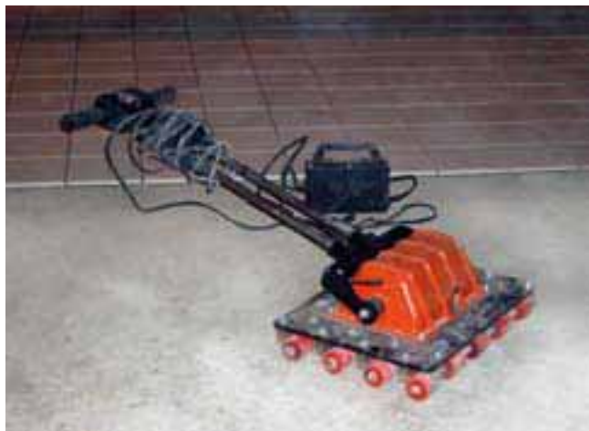
Urządzenie do wibrowania okładzin ceramicznych.
